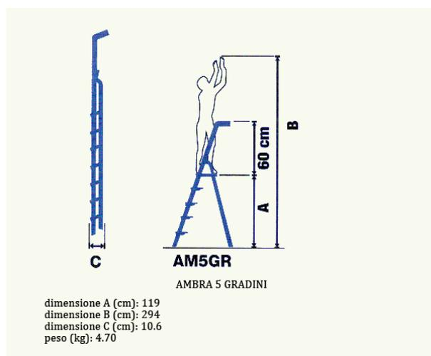
Scala a salita singola in alluminio con montanti da 45 x 22 mm e gradino da 81 mm. Dotata di piattaforma in polipropilene rinforzato con gancio blocca pedana. Fornita completa di piedini antiscivolo, cinghie di tenuta ed una capiente vaschetta porta oggetti della portata di 10 kg. Portata max 150 kg.
